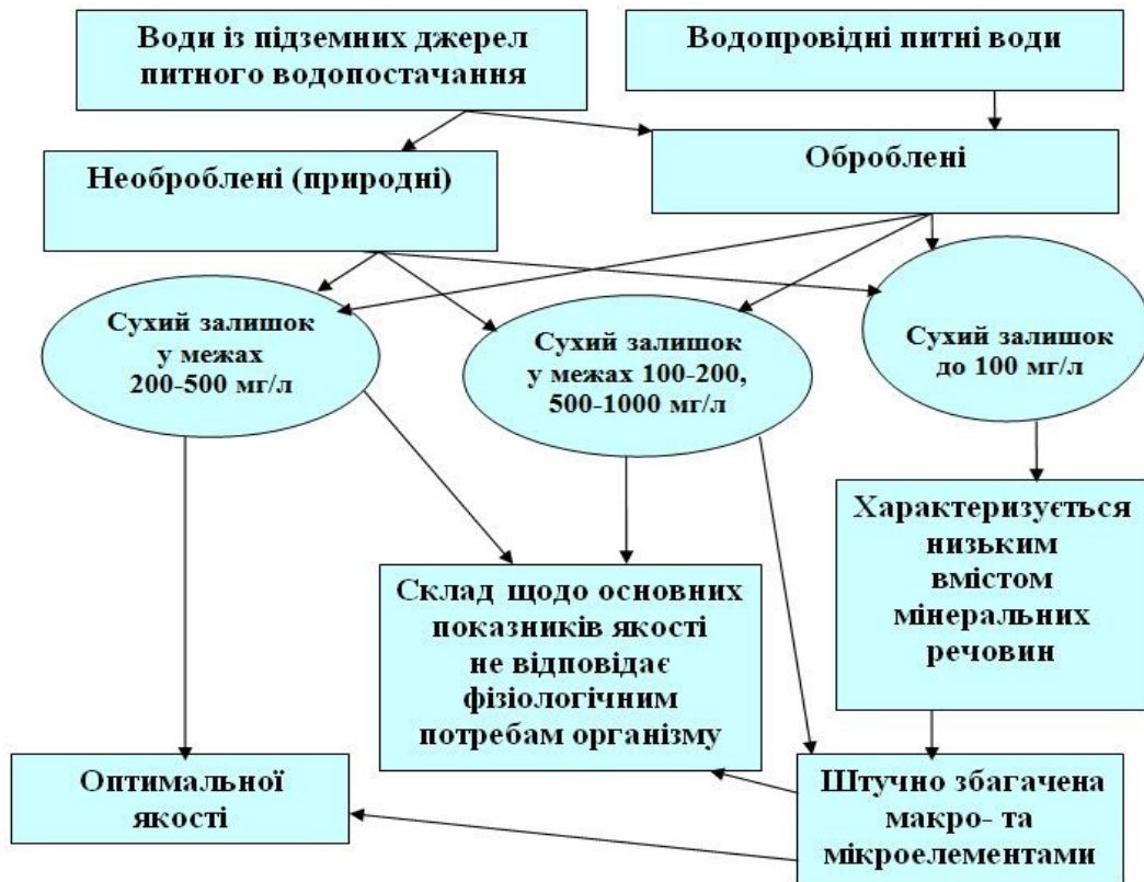
Рис. 7.9 – Алгоритм отримання різних видів питних вод поліпшеної якості.
