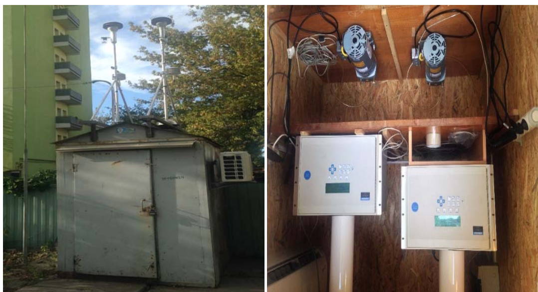
Рисунок 2.4 – Стаціонарний пункт спостереження PM_{10} та PM_{2.5}
