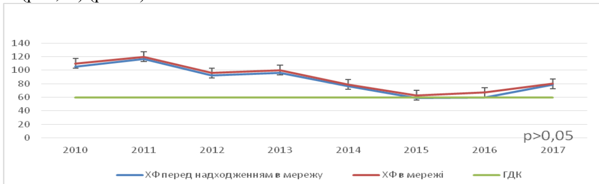
Рис. 3. Рівень хлороформу у питній воді перед надходженням до розподільної мережі та у водопровідній мережі за середньорічними показниками, мкг/дм 3 ( p > 0,05 )
