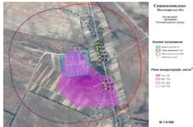
Рисунок 3. Порівняння результатів математичного моделювання поширення запахового забруднення (сірководень) зі скоригованими межами СЗЗ свиногокомплексу середньої потужності.
