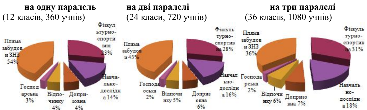
Рис.3. Питова вага площі функціональних зон для ЗЗО I-III ступенів з урахуванням різної потужності (кількості паралелей)
