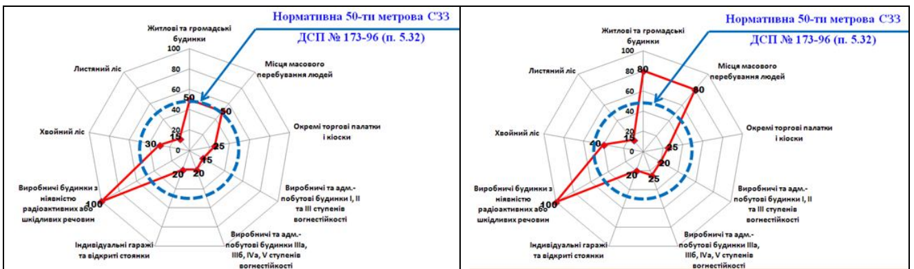
Рис. 6 Протипожежні відстані від АЗС малої потужності (з наземним розміщенням резервуару) до різних об'єктів
