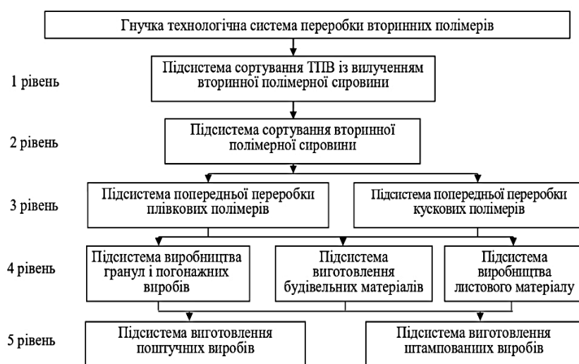
Рис. 9 – Структура гнучкої технологічної системи переробки полімерів вилучених із ТПВ.
