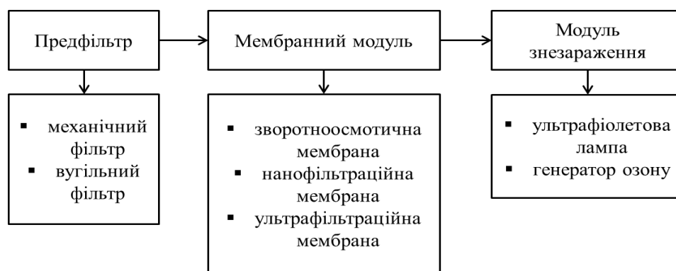
Рисунок 8 – Принципова схема будови мембранних колективних водоочисних установок
