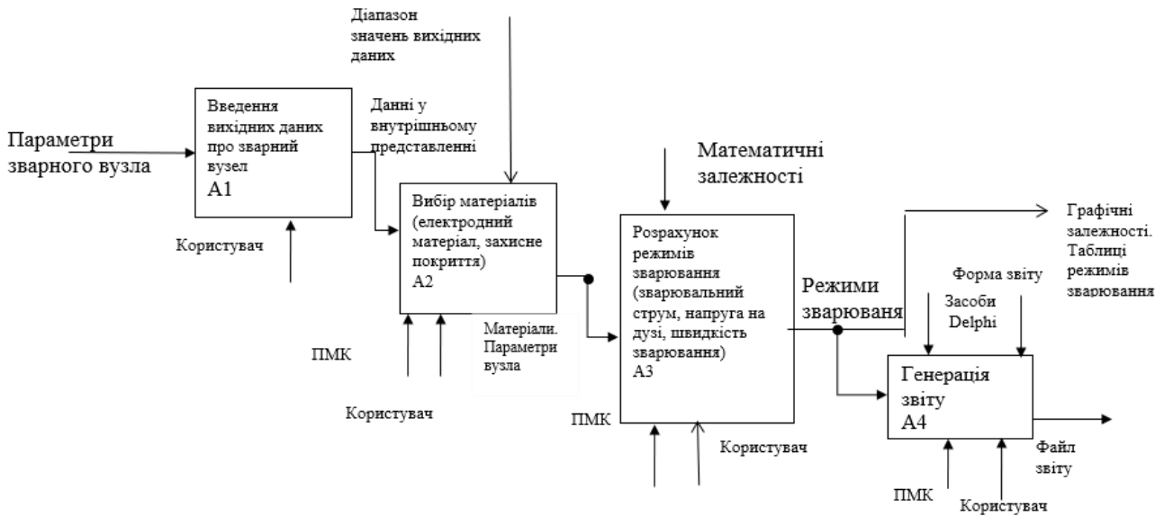
Рис. 2 – Деталізуюча структурно-функціональна SADT-діаграма першого рівня з оптимізації розрахунку технологічних параметрів зварювання по захисному покриттю
