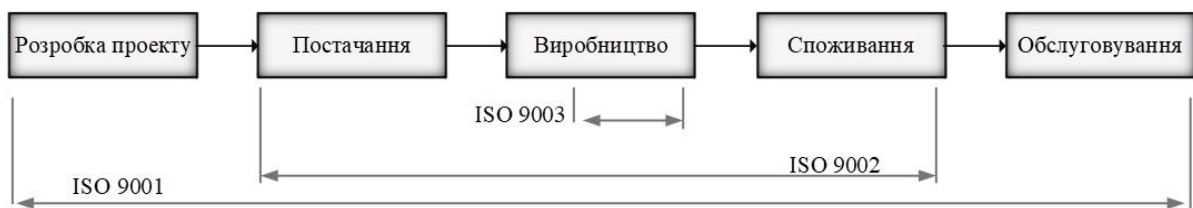
Рис. 3 – Стандарти ISO 9000 та зони їх застосування у виробничому процесі: ISO 9001 – «Системи управління якістю. Вимоги»; ISO 9002 – «Системи якості. Модель для забезпечення якості при виробництві, монтажі та обслуговуванні»; ISO 9003 – «Система якості: модель забезпечення якості при остаточному контролі і випробуваннях» (складено автором за [56])
