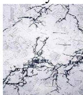
Тріщини від напруження (аустенитна нержавіюча сталь)
